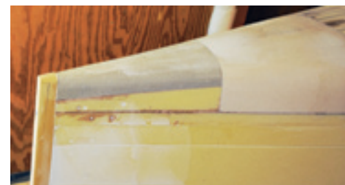
Klar til finpudsning af stævnen. Her ses stævnen, som er bygget af flere forskellige kernematerialer. Dette ses på farverne. Det yderste af stævnen er meget kraftig og trykfast, for at beskytte ved kollision.
