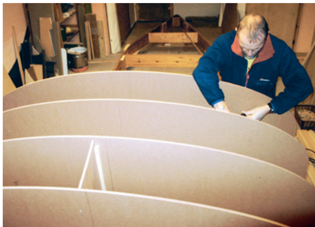
Skabelonerne er CNC-fræset med millimeter-præcision. Her stilles de op – med samme millimeter-præcision.
